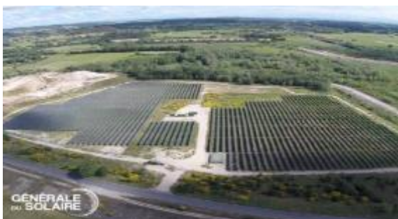
Figure 24 - Réalisation de la Générale du Solaire – reconversion d'un terrain utilisé comme décharge pour matériaux de construction, fortement pollué par des métaux lourds, en centrale solaire.
